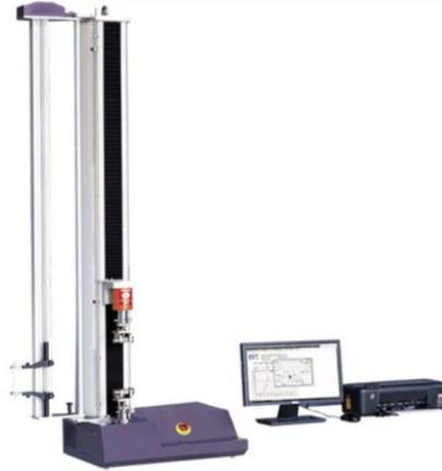
②拉力机，品牌：高铁检测仪器，型号：GT-TGS-2000，容量：20kN
