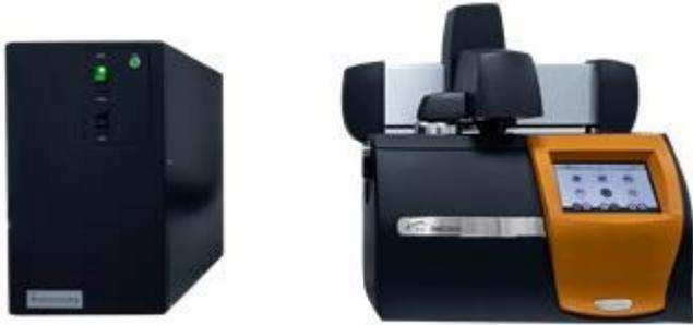
仪器二：高温差示扫描量热仪；品牌：德国耐驰；型号：DSC 404 F3；温度范围：室温~1400°C
