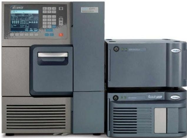
**性能指标：**柱温箱-温度范围：5-65°C；进样范围：0.1-100  $\mu$ L；检测器：示差折光检测器；RI 检测器-漂移： $\leq \pm 1.0 \times 10^{-7}$  RIU/h；泵-压力范围：0-15MPa；泵-流量范围：0.010-10.000 mL/min；检测分子量 $\leq 400000$ 。
