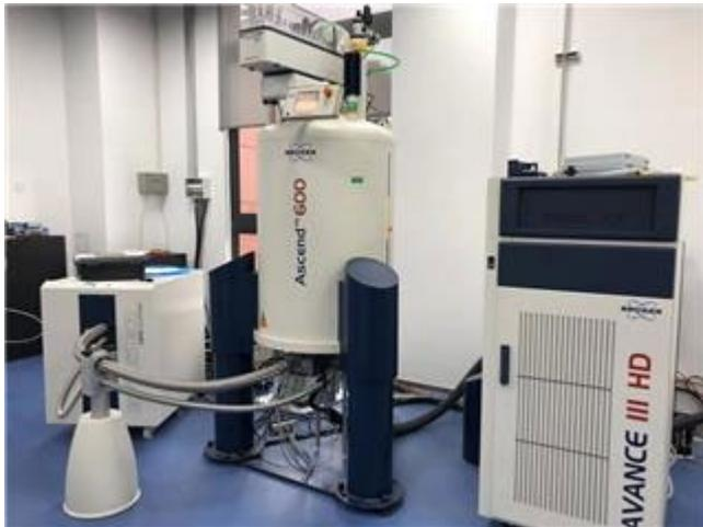
设备 3：600MHz 固体核磁共振波谱仪；品牌：Bruker；型号：AVANCE NEO
