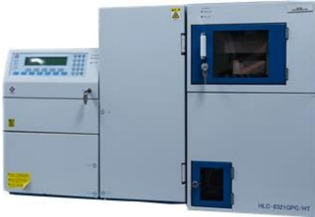
**主要应用：**溶解温度高的 PE、PP、PPS 和聚噻吩 Mn、Mw 及 Mz 分子量的测定；聚合物多分散指数（PDI）的测定；工程塑料产品质量控制。
